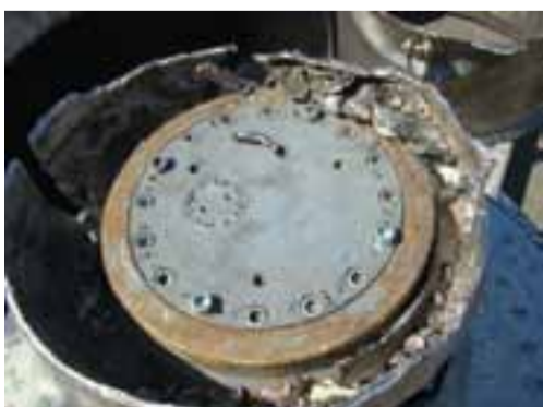
Вид контейнера SKODA VPVR/M внутри ЗДК после испытаний
